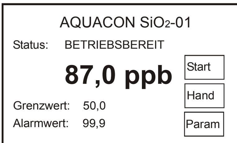
Bei einem Überschreiten des Alarmwertes (werksseitig auf die obere Grenze des Analysenbereiches eingestellt) erscheint in der Anzeige die Fehlermeldung „E-2“ und das Alarmrelais wird eingeschaltet.
